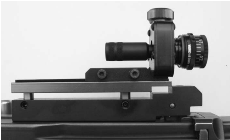
Bild 14: Diopterträger höhenverstellbar zu Stgw 57 diverse Fabrikate
